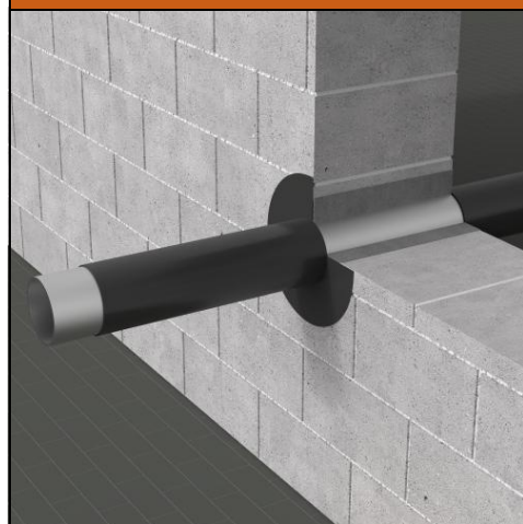
Rys. 1. Przejście w ścianie sztywnej A ≥ 150 mm
