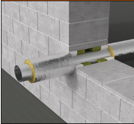
Rys. 1 Przejście w ścianie A \geq 150 mm
