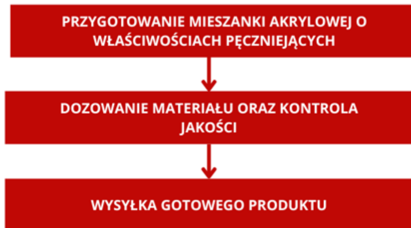
Rysunek 5.2: Uproszczony proces produkcji mas ogniochronnych
