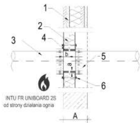
Rys. C3. Uszczelnienie przejścia instalacyjnego rur z tworzyw sztucznych bez izolacji, przez ścianę podatną lub sztywną, wykonane za pomocą kołnierzy INTU FR COLLAR L SLIM (uszczelnienie dwustronne)
