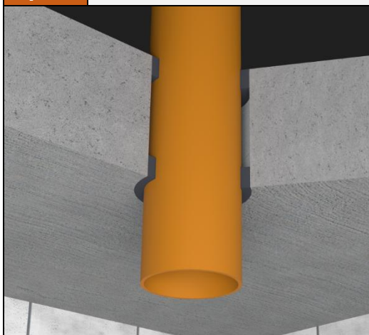
Rys.7 Uszczelnienie przejść rur palnych w stropie sztywnym o grubości A \geq 150 mm i gęstości \rho \geq 550 kg/m 3
