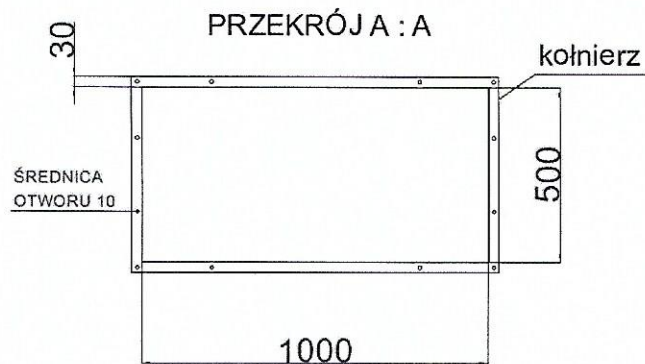
WIDOK SZCZEGÓŁOWY - GÓRNE I BOCZNE USZCZELNIENIE
